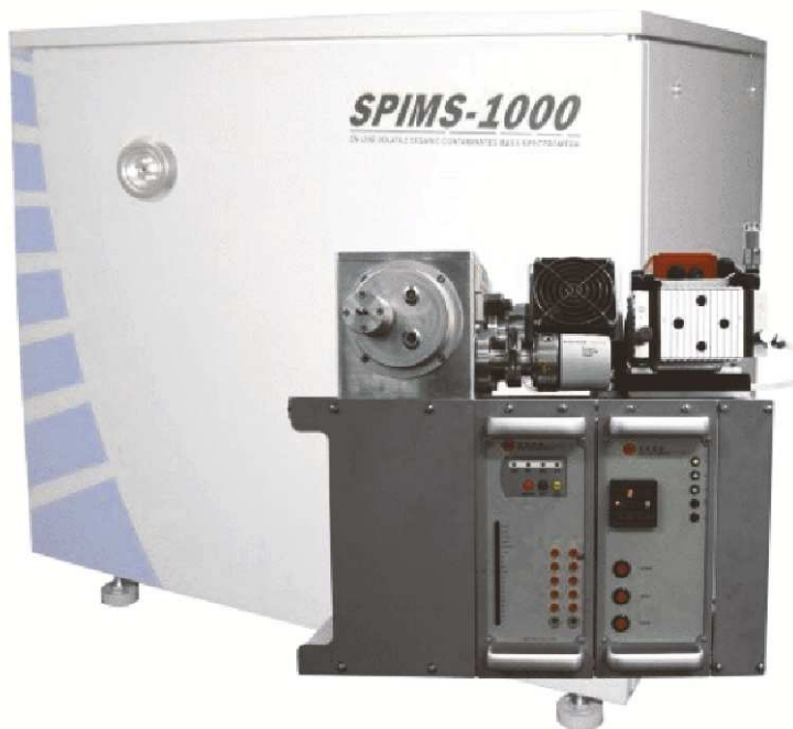
图1 SPIMS-1000 在线挥发性有机物质谱仪
