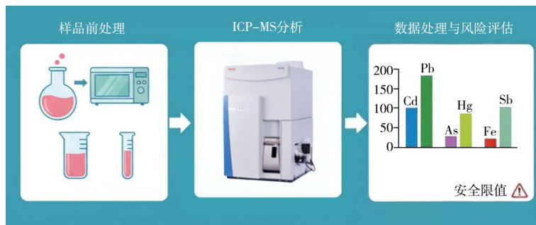
图3 ICP-MS技术检测儿童化妆品中化学安全风险物质的常规实验过程
