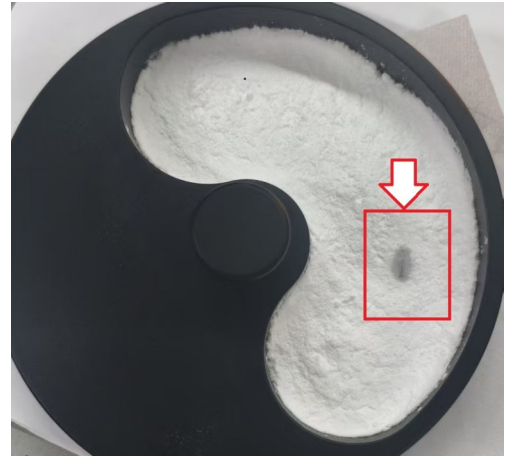
图7 硬脂酸在设备I样品盘中出现熔化现象
